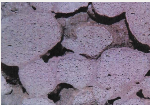
Gefügestruktur von zementgebundenem MISAPOR 10/50 im Querschnitt
