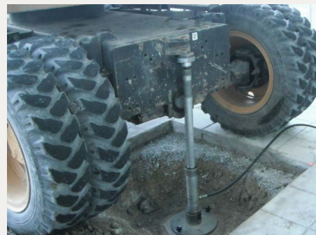
Lastplattenversuche auf MISAPOR 10/50 zementgebunden, Einbaudicke = 20 cm
